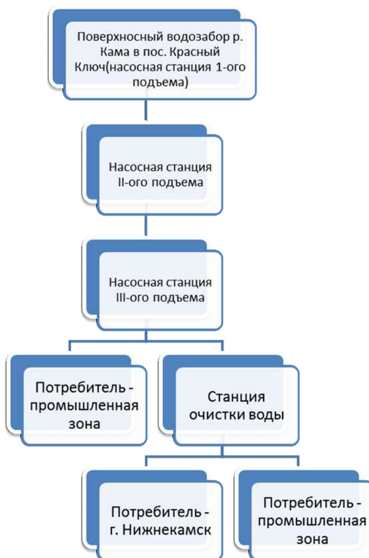
Рис.1.1.2 Структура централизованной системы водоснабжения
